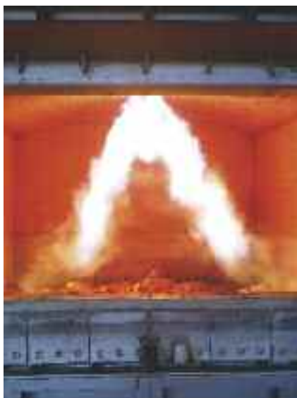
Rysunek 5. Zdjęcie palnika THB pracującego w piecu płomiennym - aluminium.
